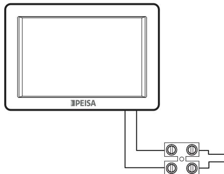
Para la conexión eléctrica del termostato de ambiente es necesario quitar el puente eléctrico en la bornera prevista en el interior de la caldera y conectar allí los cables provenientes del termostato.
